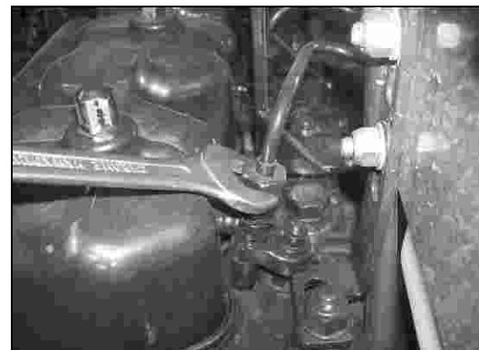
A—Fuel Return Line B—Hand Primer
