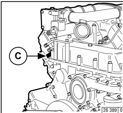
Фирменная табличка **C** закреплена на картере.
