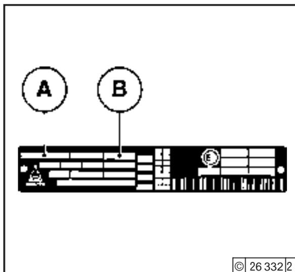
Конструктивное исполнение **A**, номер двигателя **B**, а также рабочие характеристики, указаны на Ффирменной табличке. В заказах на запасные части должны указываться модель и номер двигателя.
