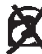
Les rondelles d'étanchéité utilisées pour ces moteurs sont exemptes d'amiante. Veuillez employer, lors des travaux d'entretien et de réparation, les pièces de rechange correspondantes.
