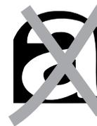
Le guarnizioni utilizzate per questo motore sono senti da amianto. Per i lavori di manutenzione e di riparazione fate uso degli appositi ricambi.
