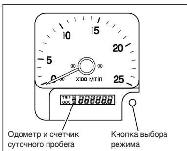
Одометр и счетчик суточного пробега
