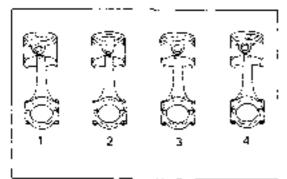
(d) Arrange the piston and connecting rod caps in order.
