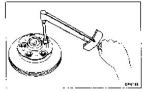
(d) Install a new rotor drsc. Torque the holts.
