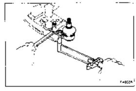
INSTALL LOWER BALL JOINT TO LOWER ARM Torque: 700 kg-cm (51 ft-lb, 69 N·m)
